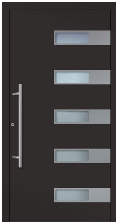
A 12312 U_g -Wert 0,82 1) Farbe: RAL 8077 Braun FS Verglasung: Satinato weiß LA 84 x 284 / 1.600 mm Applikationen in Edelstahloptik außen Mindestmaß = 1.000 x 1.990 mm
